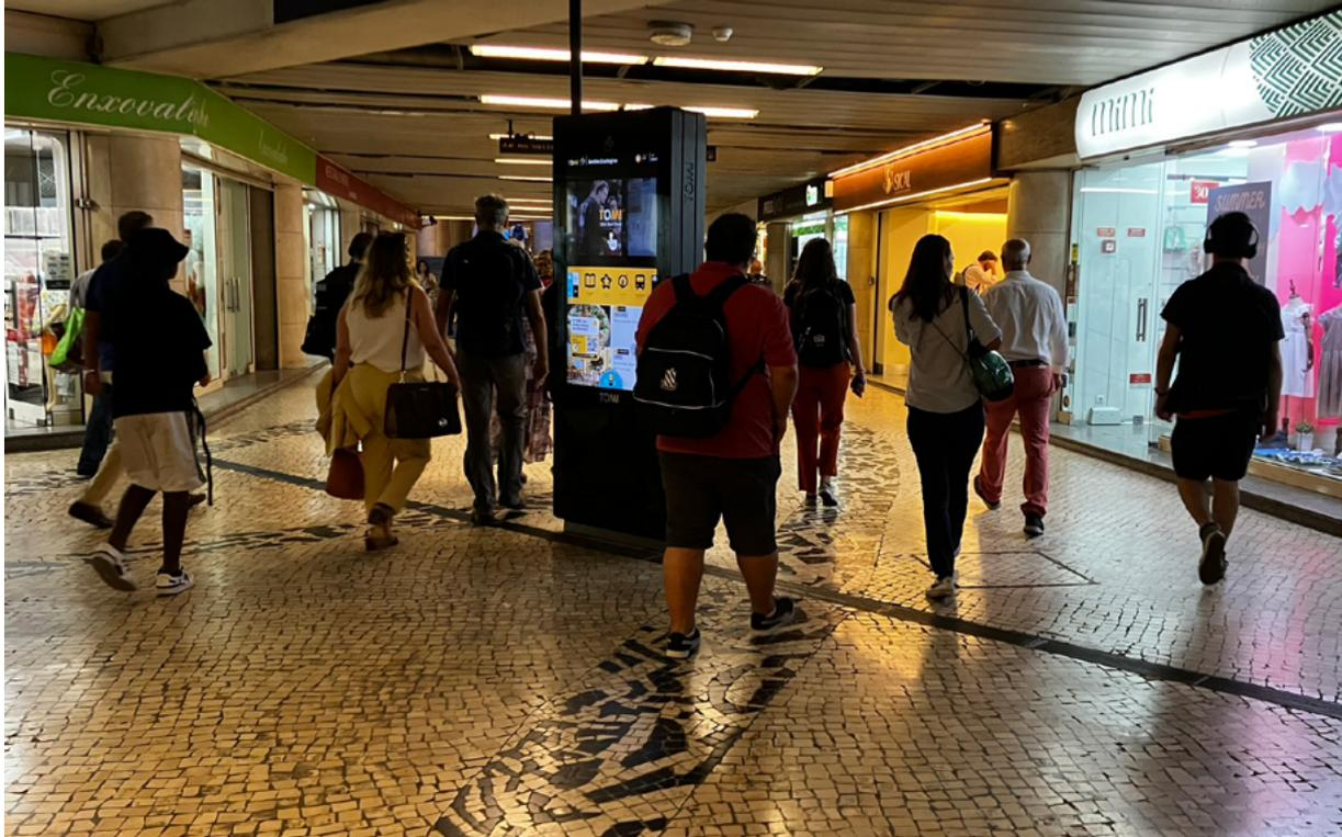
**Figura 5:** Exemplo de má prática: colocação de painel de informação no centro do corredor, obrigando ao desvio de fluxos e redução do campo de visão [Fonte própria]
